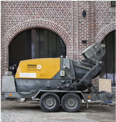
Pompe à béton stationnaire
