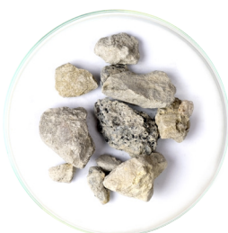
Béton broyé et lavé
